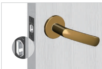
ハンドルを下げてラッチボルトが完全に引き込めない
