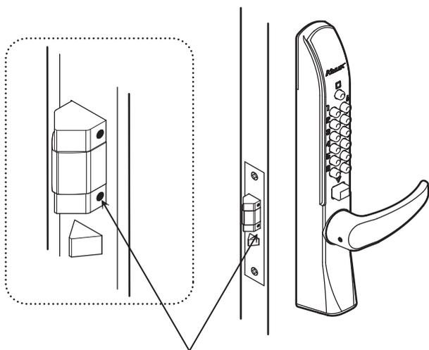
開扉時のラッチボルト側面に赤い●印が見える
