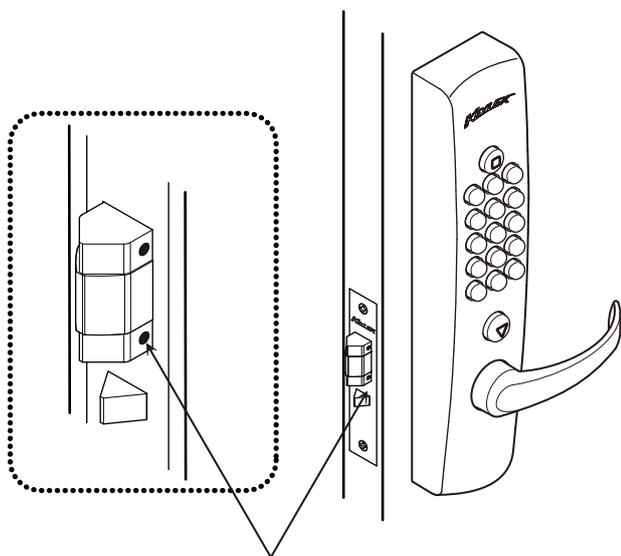
開扉時のラッチボルト側面に赤い●印が見える
