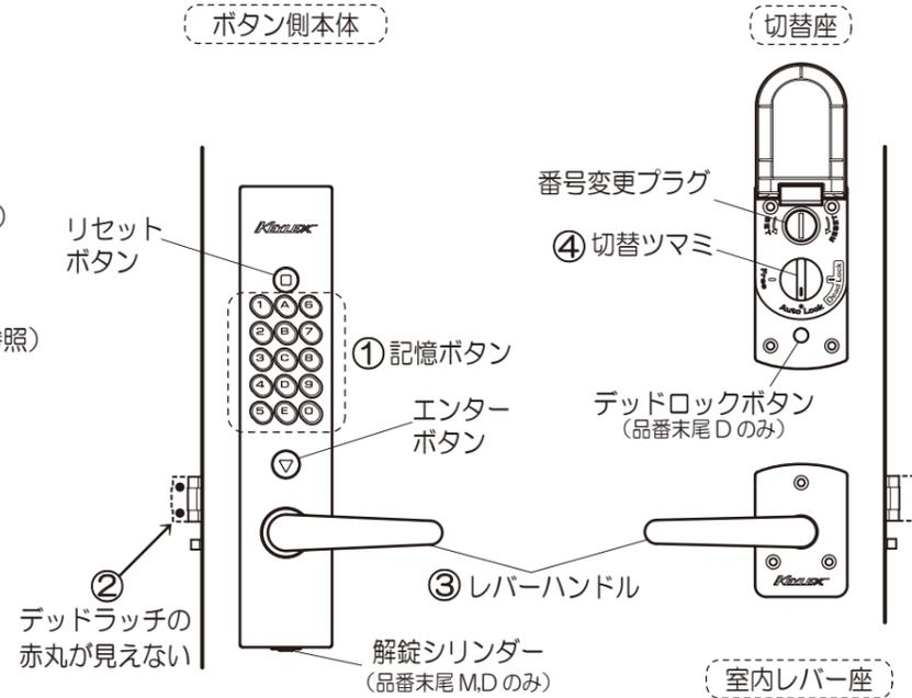
④ 切替ツマミの位置で室外側からの施錠方法が替わります。室内側からは、切替ツマミの位置にかかわらずレバーハンドル操作で解錠できます。
