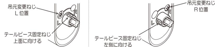
5 作動確認：ロックターン、サムターンが作動しない場合は、記憶番号、テールピースの取り付け位置、吊元変更ねじの位置とテールピース固定ねじの向きを確認してください。
