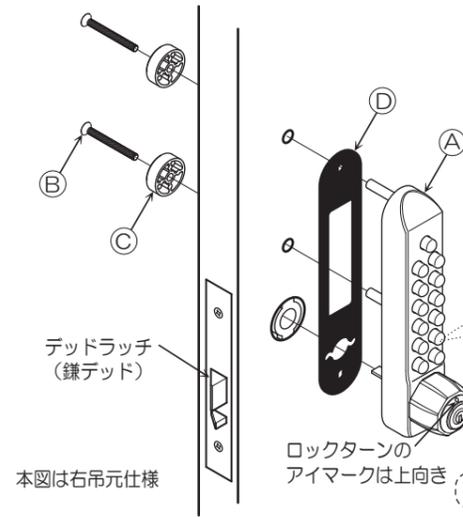
錠のデッドラッチ (鎌デッド) が収まっている状態で取り外します。
