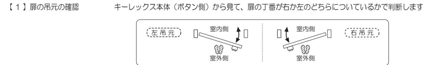
【2】キーレックス本体の吊元対応 レバータイプの KL は左吊元時にレバーハンドルの向きを変える必要があります
