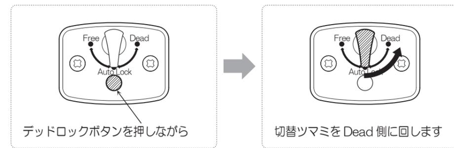
デッドロックから自動施錠へは、切替ツマミを Dead → Auto Lock へ回します（デッドロックボタンは押さない）
