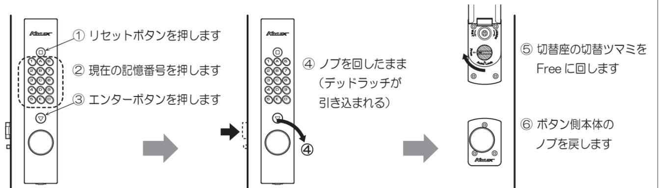
【空錠】Free から【自動施錠】Auto Lock へは、ボタン側本体のノブを回したまま、切替座の切替ツマミを Auto Lock に回します
