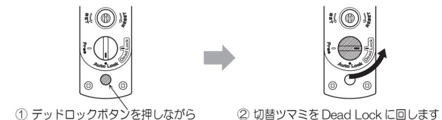
【デッドロック】から【自動施錠】へは、切替座の切替ツマミを Dead Lock → Auto Lock へ回す (デッドロックボタンは押さない)
